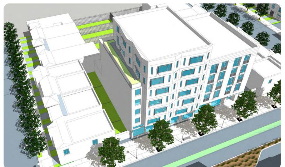
當新住房的側面毗鄰現有的後院時，體量必須在55英尺的高度下退縮10英尺。
